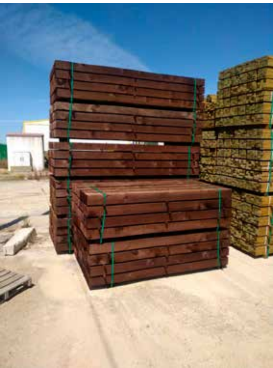
Traviesas tratadas con Tanasote
